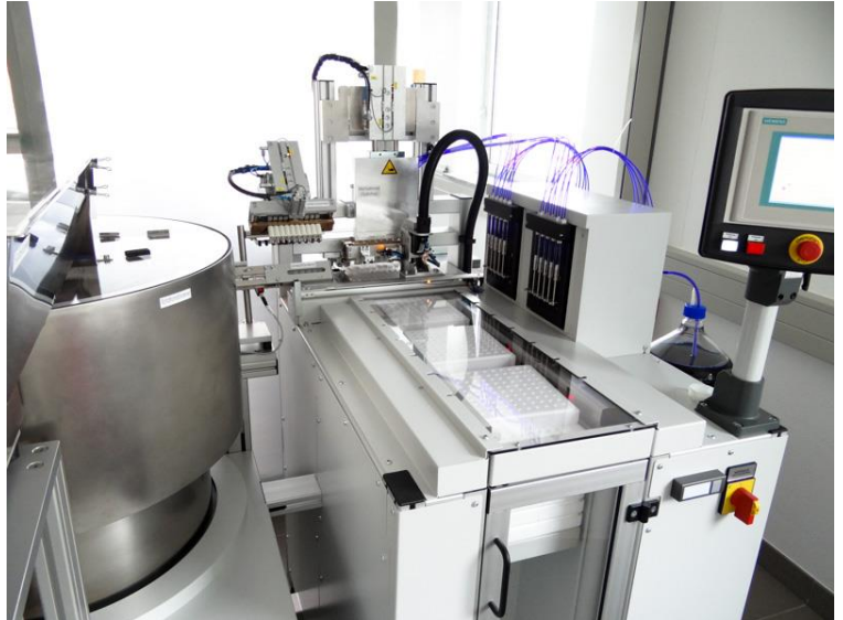
Automat zum präzisen Abfüllen von diagnostischen Flüssigkeiten (Quelle: Fa. Bioanalytic GmbH)
